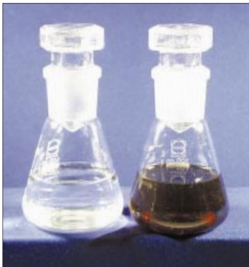
Abb. 2: Die Dunkelfärbung des Wärmeträgers rechts (pH-Wert 6,8) gegenüber dem ungebrauchten Wärmeträger (pH-Wert 8,2) zeigt den Alterungsprozeß deutlich.
