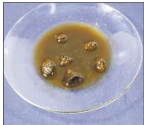
Abb. 3: Eindeutiger Qualitätsunterschied: ein thermisch leicht beschädigter Wärmeträger mit auflösbaren Rückständen (oben) gegenüber einem Medium mit nicht auflösbaren Rückständen (unten)
